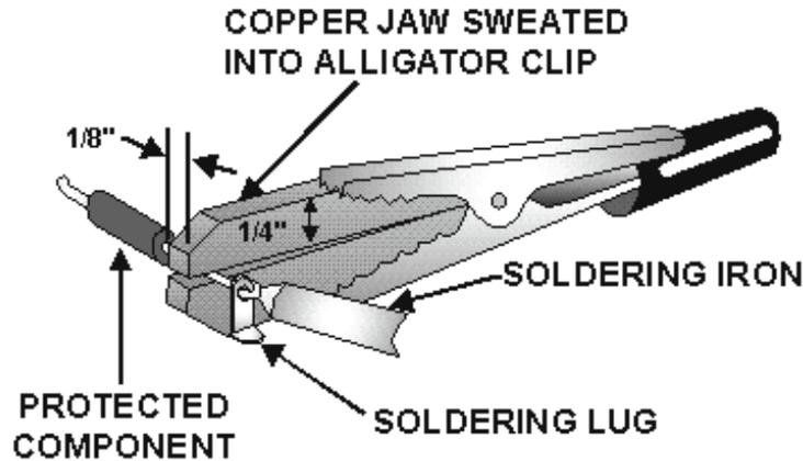
Figure 2-37.—Heat shunt.
