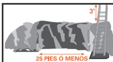
Una persona competente debe inspeccionar las zanjas a diario y cuando las condiciones cambien. Una zanja sin protección es una tumba. No entre a una zanja que no está protegida.
