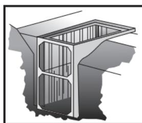
Los materiales excavados o de otro tipo y los equipos deben estar por lo menos a 2 pies hacia atrás del borde de la zanja.
